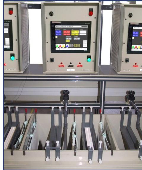
Beschichtungsstation mit Vor- und Fertignickelvorrichtung (links) und Diamantvorrichtung (rechts)
